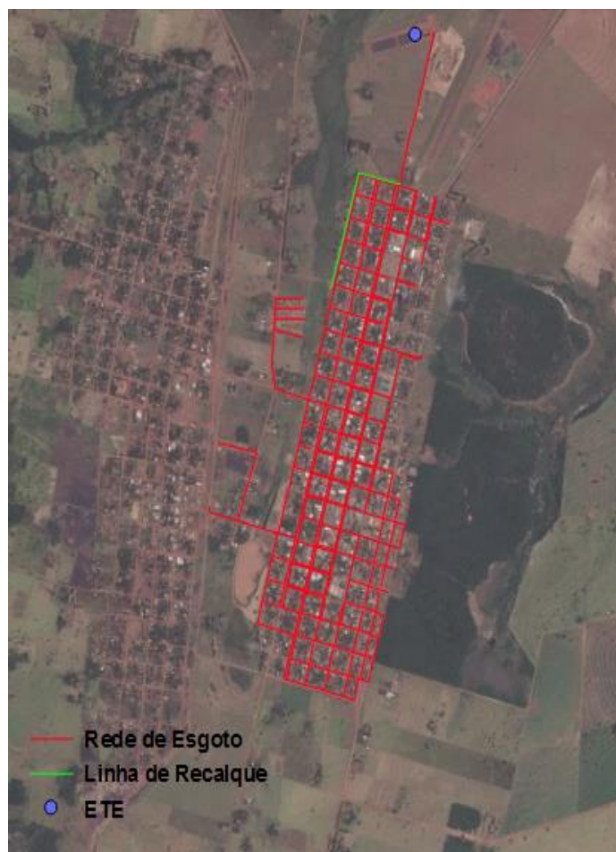
FIGURA 6: COBERTURA DA REDE COLETORA DE ESGOTO DE PARANHOS.
