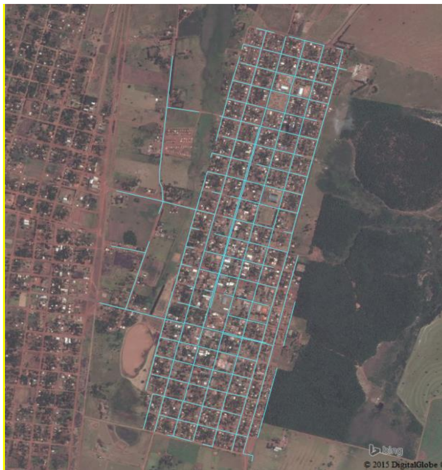
FIGURA 3: REDE DE ABASTECIMENTO DE ÁGUA DE PARANHOS.
