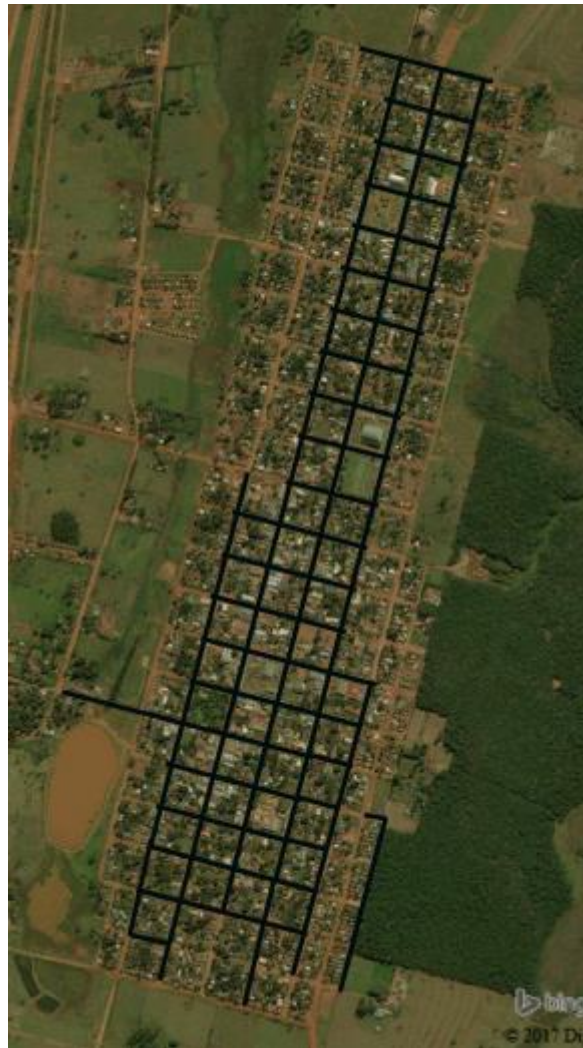
FIGURA 2: VIAS PAVIMENTADAS NO MUNICÍPIO DE PARANHOS.
